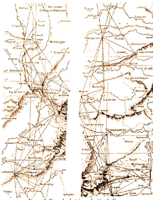
Figura 3. Ejemplo de triangulación de Gauss.
