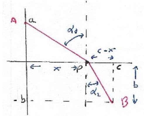
FIGURA 4. Refracción de la Luz.
