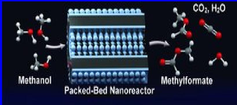
Membrana de óxido anódico de aluminio que contiene nanopartículas de sílice en un **nanotubo de sílice**, que incluye **nanopartículas de Pd** utilizada para preparar un nanoreactor de lecho empaquetado. Este **nanoreactor** muestra una excelente eficiencia en la descomposición de metanol en fase gaseosa, y el formiato de metilo producido como el producto de oxidación parcial se obtiene con alta selectividad.
