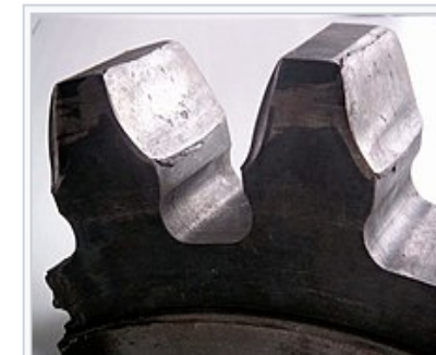
Desgaste en los dientes de un engranaje debido a la fricción.
